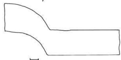
Aletta a quarto di cerchio ribassato, incavata inferiormente per tutta la lunghezza, per il sistema di assemblaggio
